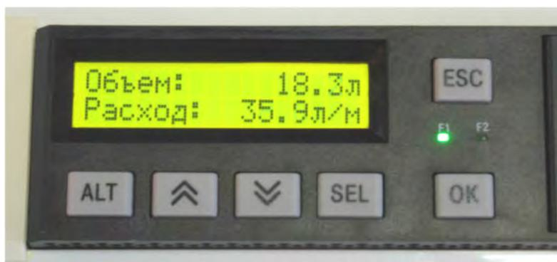
Рисунок 16 – Лицевая панель СКЭ-01 в режиме эксплуатации
