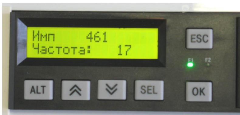
**Рисунок Ж.2 – Режим просмотра счетчика импульсов**
