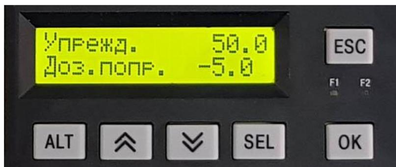
Рисунок Ж.10 – Ввод упреждающего импульса
