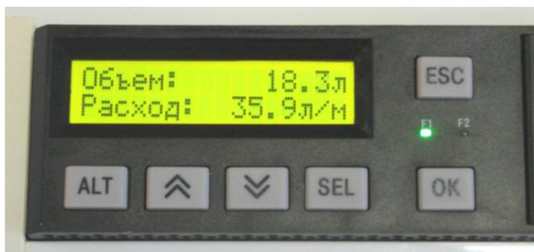
**Рисунок Ж.1 – Лицевая панель «СКЭ-01» в режиме эксплуатации**
